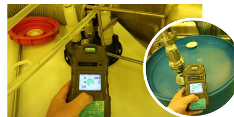
吨桶改造后VOCs逸散浓度显著降低
