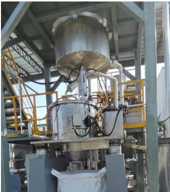
富士胶片印版（中国）有限公司建设MVR蒸发浓缩装置，减少废水中总铝、TDS浓度
