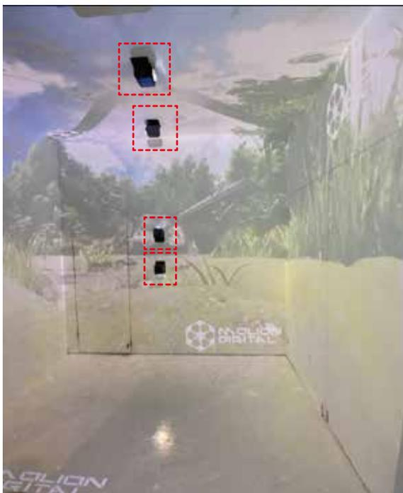
5台FP-Z5000投影机，只需露出镜头光源部分，隐藏式安装，镜头360°全方位旋转投影，大范围镜头位移。
